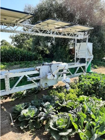
Unternehmensvision: Der vom Startup AI.Land entwickelte halbmobile Agrarroboter „Davegi“ soll pro Tag das Bestücken von 60 Gemüseboxen ermöglichen. ©AI.Land
