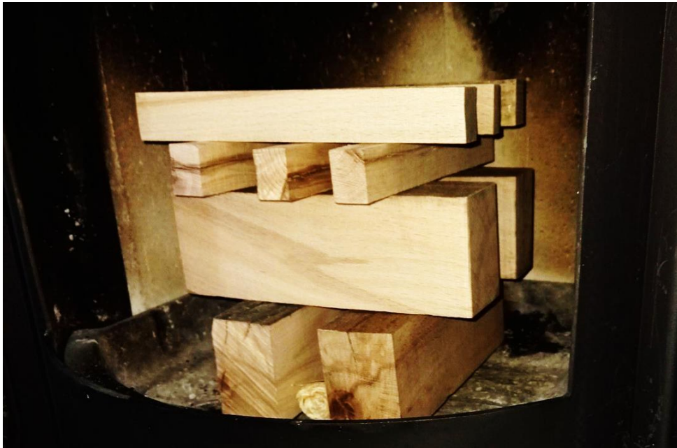
Abb. 2: Versuchsaufbau: Schichtung von Brennholz und Anzündern (paraffinetränkte Holzwole) zum Anzünden des Kamins.
