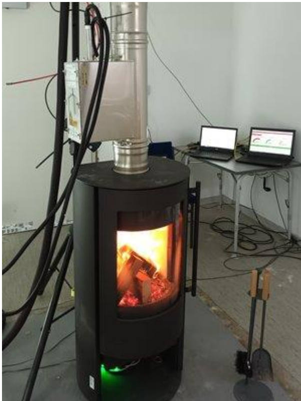
Abb. 1: Kaminofenprüfstand des HLNUG mit elektrostatischem Abscheider
