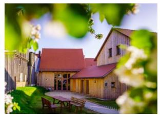
Neben den Dorfhäusern wurde auch die Dorfscheune der Hollerhöfe renoviert. Die komplette Holzverschalung wurde abgenommen und die Wände neu gedämmt. Innen ist das Holzfachwerk sichtbar geblieben. Auch das Dach wurde neu gedämmt und mit Biberschwanz eingedeckt. Die Dorfscheune ist für Veranstaltungen jeglicher Art buchbar. Neben Hochzeiten und privaten Feiern, vermieten die Hollerhöfe die Dorfscheune auch oftmals für Tagungsworkshops und Firmenevents.
