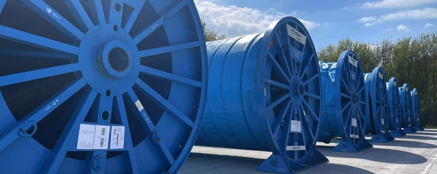
Im hessischen Philippsthal im Landkreis Hersfeld-Rotenburg lagern wir bereits Kabeltrommeln – in der Spitze werden dort 150 Trommeln vorgehalten. Sie sind bereits in der Länge vorkonfektioniert und bereit für den späteren Einsatz.
