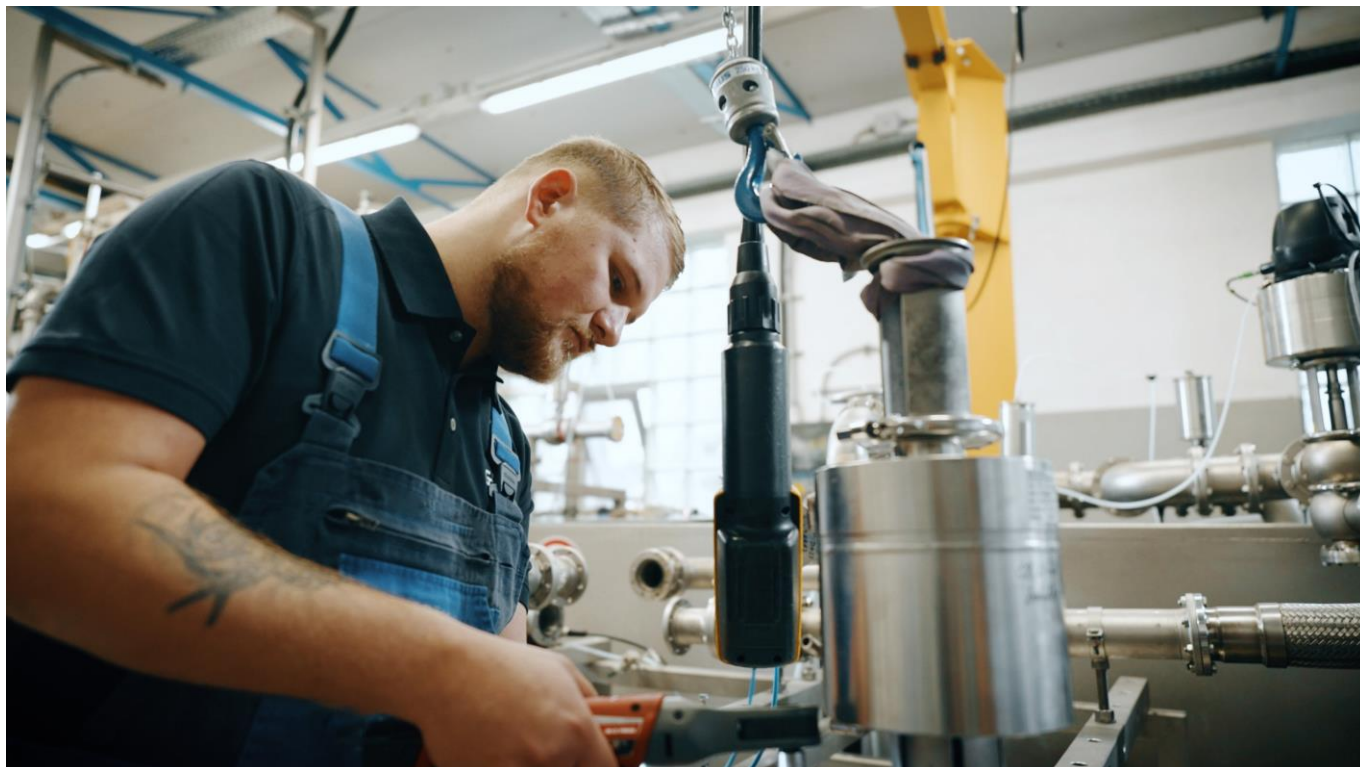
Abb. 1: Ungenügend gesicherte Prozessanlagen sind häufig Unfallursachen in der Produktion. Deshalb rüstet GEA nun auch die aseptischen Doppelsitzventile der Aseptomag-Reihe mit LockOut-TagOut-Absperrungen (LoTo) aus. Quelle: GEA
