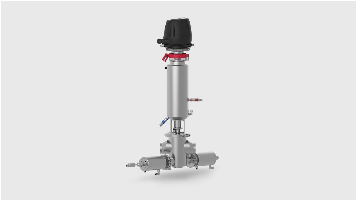
Abb. 2: Die Doppelkammerventile GEA Aseptomag Typ DK haben für LoTo den Ventilantrieb verändert, der nun eine spezielle Laterne und Kolbenstangenverlängerung für den Steckbolzen nutzt. Quelle: GEA
