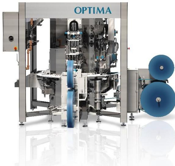
Die OPTIMA CFR ist eine sehr kompakte Maschine, die beispielsweise Kaffee, Tee oder Instantpulver in Kapseln dosiert. Für eine kurze Time-to-Market ist die Maschine besonders schnell verfügbar. (Quelle: Optima)
