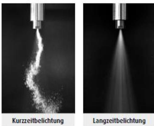
**Bildunterzeile:** Die X-Jet düsen erzeugen einen oszillierenden Tropfenstrahl.
