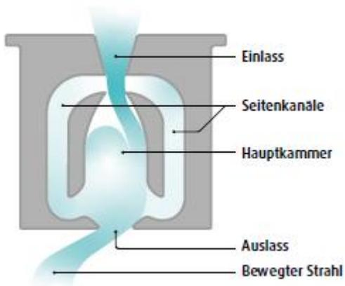
**Bildunterzeile:** Das Funktionsprinzip: Die X-Jet Düsen erzeugen ohne bewegliche Teile einen schwingenden Wasserstrahl.
