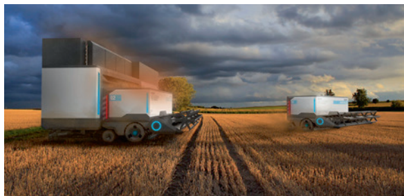
Bild 5. Getrenntes Mähen und Dreschen bei der Getreideernte (Quelle: TU Dresden)
