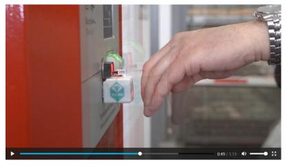
Mit TOBI wird es erstmals möglich, Taster und Schalter in Gebäuden mit Publikumsverkehr kostengünstig und zuverlässig berührungslos bedienbar zu gestalten, ohne das größere technische Umbauten notwendig sind.
