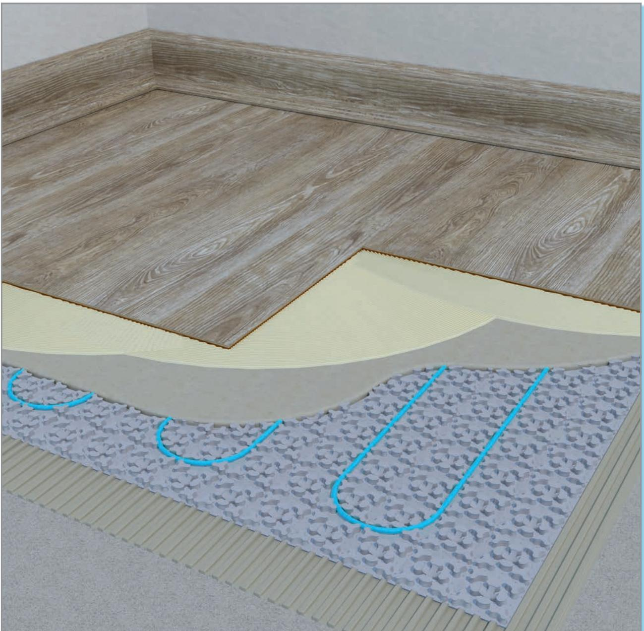
Designböden sind beliebt. Doch der Einbau einer elektrischen Fußbodenheizung unter solchen Bodenbelägen war lange kritisch. Auf dieses Problem hat Gutjahr mit IndorTec THERM-E reagiert. Das System gibt die Wärme gleichmäßig ab, ohne dass an einzelnen Stellen Temperaturspitzen auftreten – und ist damit ideal für Bodenbeläge aller Art.
