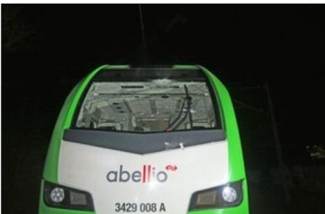
*Das Triebfahrzeug wurde durch die von einer Brücke herabhängenden Pflastersteine stark beschädigt.*
