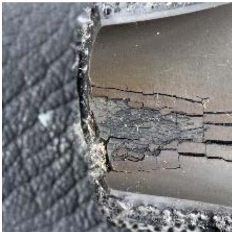
Blatt 2.2.10 und Blatt 2.2.7 der Richtlinie VDI 3822 helfen bei der Schadensprävention an Elastomerprodukten (Bild: Adam Opel AG).
