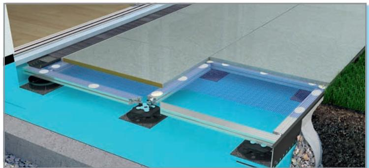
Damit Großformate wirklich schön bleiben, brauchen sie die richtige Unterkonstruktion. Die neueste Entwicklung von Gutjahr ist ein Rahmensystem aus Aluminium. Mit TerraMaxx RS lassen sich XXL-Formate mörtelfrei auf einem Aluminium-Rahmen verlegen. Das garantiert einen planebenen Untergrund, die einfache Herstellung eines Gefälles und die schnelle und witterungsunabhängige Verlegung.
