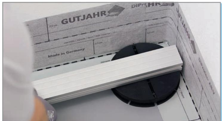
Das höhenverstellbare TerraMaxx PL-H ist gerade bei unebenen Untergründen ein echter Problemlöser. Dank der neuen Acht-Arm-Technologie balanciert es die Unebenheiten geschickt aus und hält die Platten in einer waagerechten Position. Beide Stelzlager können als direkte Auflage für Keramikelemente und Betonwerkstein verwendet werden. Zudem eignen sie sich als Unterbau für das neue Gutjahr-Aluminium-Rahmensystem.
