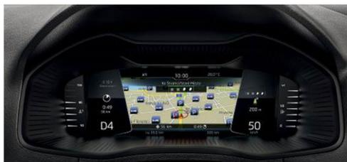
Das **Basic-Layout** zeigt zwei ausgewählte digitale Informationen im Großformat an, zum Beispiel die gefahrene Geschwindigkeit und die verbleibende Reichweite. Zusätzlich können oben und unten im Display Grundinformationen (Uhrzeit usw.) dargestellt werden. Mit aktivierter Navigations-Zielführung sind in der Mitte auch die Navigationspfeile sichtbar.
