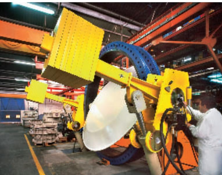
Neue Schwenkantriebe für Klappen tragen zum sicheren Absperren großer Wasserpipelines bei.
