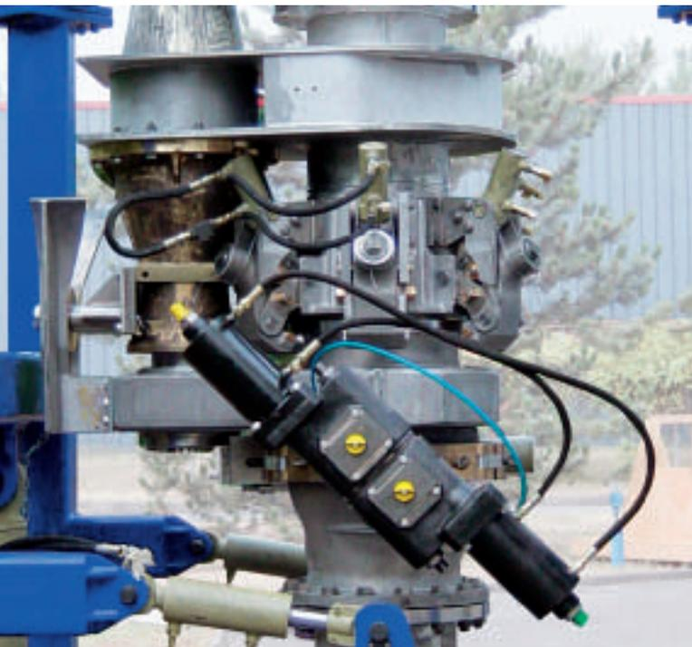
Mit einem von KSB entwickelten Kupplungssystem funktioniert das erste flexible Terminal, um Flüssiggas auf offener See zu verladen.
