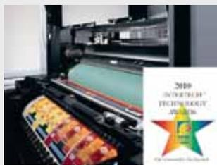
Das prämierte Inline-Bogeninspektionssystem der Heidelberger Druckmaschinen AG, Prinect Inspection Control, kann dank eines hochauflösenden Zweikamerasystems Druck- und Materialfehler frühzeitig erkennen. Fehlerhafte Bögen landen bereits markiert im Auslegerstapel und können nach Beseitigung des Fehlers direkt oder später entnommen werden. So lassen sich Makulatur- und Nachbearbeitungskosten deutlich reduzieren und besonders hohe Qualitätsanforderungen unserer Kunden realisieren.
