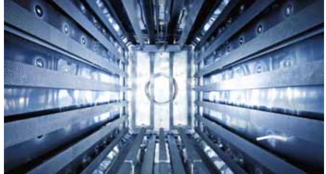
▮ Oben: CFC-Heizelemente des neuen Lötovens Links: Rückansicht des Lötovens mit Hochvakuum-pumpstand
