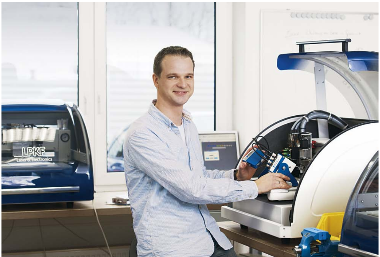
LPKF-ProtoMaten arbeiten auch ohne Laser mit einer Auflösung von bis zu 2 Mikrometer.
