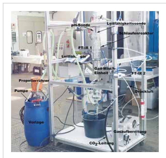
Abbildung 1: Schlaufenreaktor Versuchsstand im Technikum des I.U.T.A.
