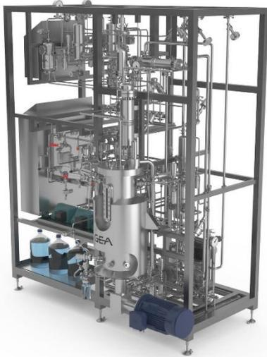
Der vielseitige Bioreaktor GEA Axenic P dient der Zellkultivierung und Präzisionsfermentation für New-Food-Anwendungen wie kultiviertes Fleisch, präzisionsgefertigte Milchprodukte oder Pilzmyzel im Pilotmaßstab. Quelle: GEA
