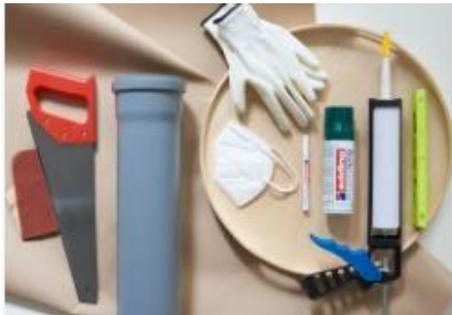
2. Zunächst das Kunststoffrohr in drei gleich große Abschnitte einteilen. Bei einem Rohr von 1m Länge sollte jedes Teil ca. 33cm lang sein. Mit dem Glanzlackmarker die Abschnitte markieren.
