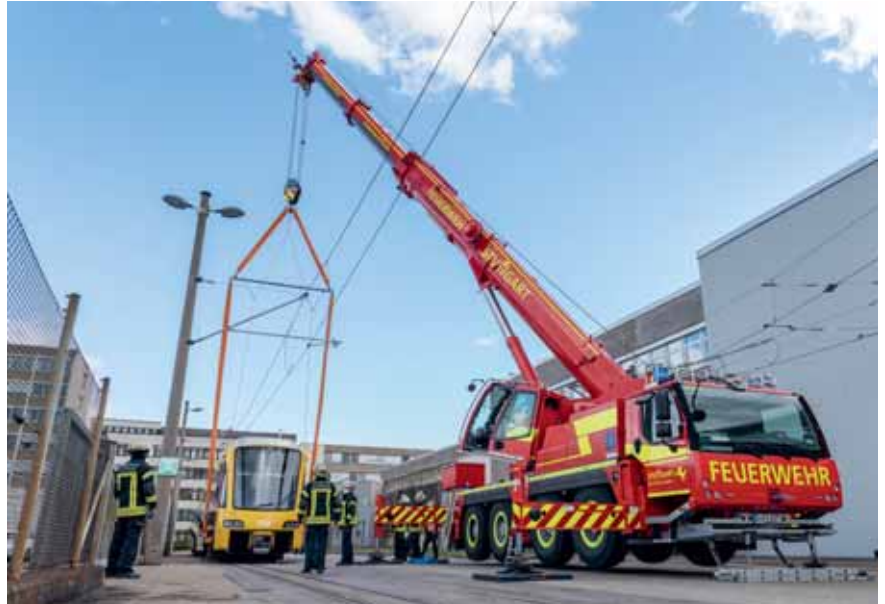
Anheben einer Stadtbahn mit einem Feuerwehrkran
