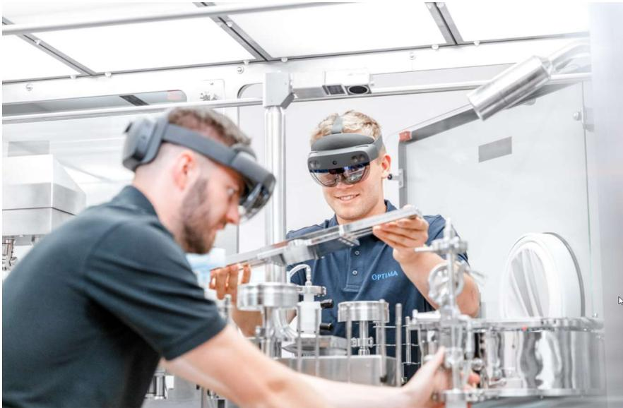
Augmented-Reality-Anwendungen sind ein wichtiges Tool in der Pharmaproduktion. Da Maschinenbediener Schritt für Schritt durch den Formatwechsel geführt werden, sinkt das Risiko für Maschinenstillstände und die Verfügbarkeit nimmt zu. Auch Produktverluste werden so auf ein Minimum reduziert. (Quelle: Optima)
