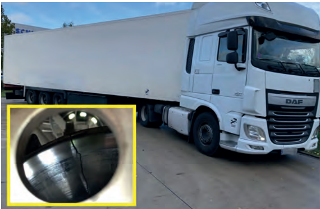
Gerissene Brems Scheibe des Aufliegers Fotos: KPB Mettmann
