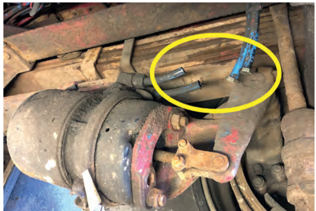
Abgeklemmte Bremsleitungen mittels Schrauben
