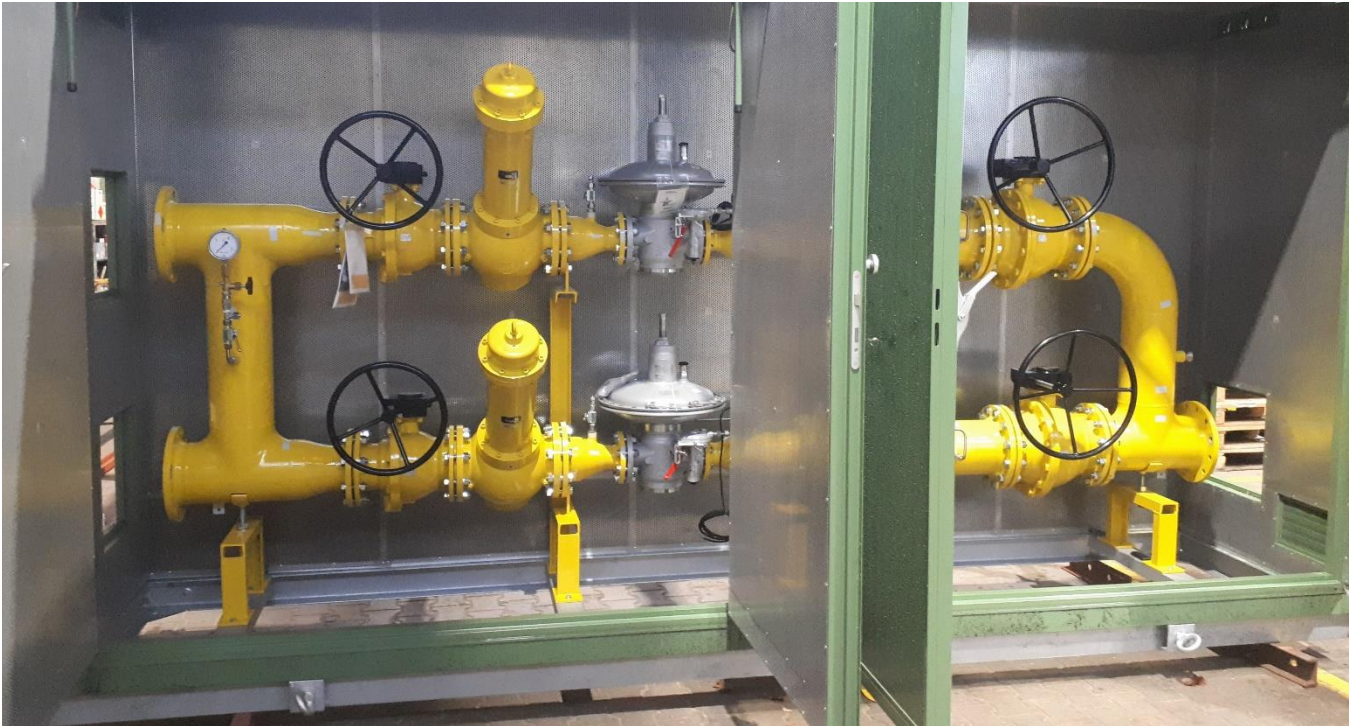
Bereit für den Transport zum Kunden: Die von SPIE konstruierte Wasserstoffeinspeiseanlage in einem Aluminiumschrank. Copyright: SPIE
