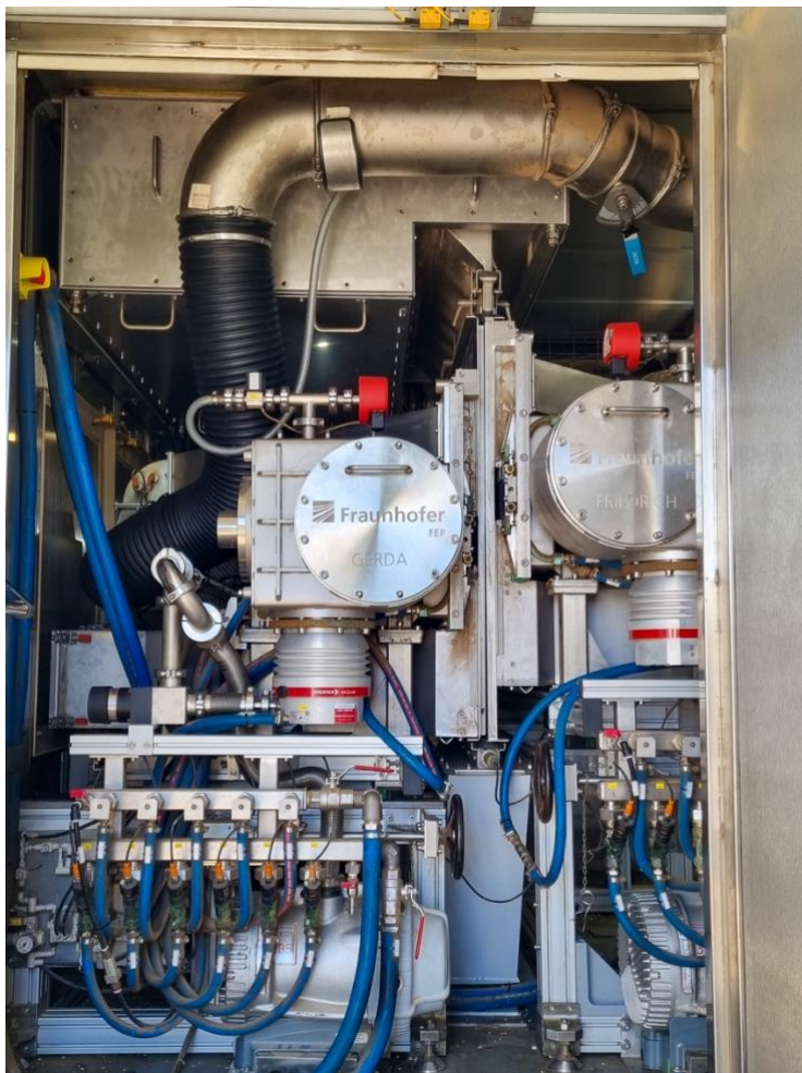
Die mobile Anlage auf einem Lkw kann 25 Tonnen Saatgut pro Stunde aufbereiten, Bild: E-VITA GmbH
