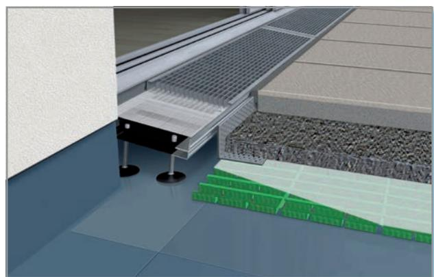
Für den Einsatz im Türanschlussbereich hat Gutjahr das Komplettsystem aus dem Spezialdrainrost AquaDrain BF-Flex und passenden Flächendrainagen entwickelt. Das Drainrostsystem wird vor Balkon- und Terrassentüren oder vor bodentiefen Fenstern eingebaut. Es kann auch schräg als Rampe gesetzt werden. Dabei entspricht es sowohl den Flachdachrichtlinien als auch den Regeln für barrierefreies Bauen.
