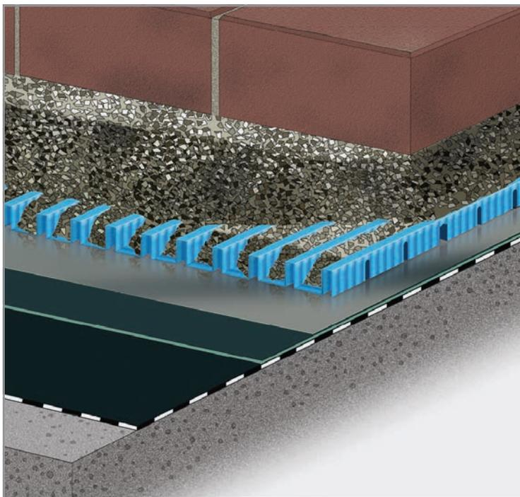
Grund hierfür: Natursteine wie Granit, Basalt und Sandstein reagieren besonders empfindlich auf Stauwasser unter dem Belag. Hässliche Kalkablagerungen, hartnäckige Feuchtflecken und Frostschäden sind möglich, und die Sanierung ist dann aufwändig und teuer. Deshalb muss das Wasser, das über die Fugen unter den Belag gelangt, besonders schnell und gründlich abgeleitet werden – am besten über Gutjahr-Flächendrainagen.
