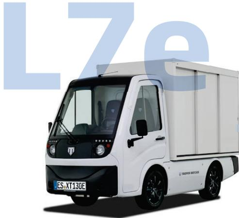
Schweres vierrädriges Kraftfahrzeug, das nicht unter L6e fällt, mit einer Leermasse bis 450 kg (bis 600 kg für Güterbeförderung) ohne Batterien und max. Nutzleistung bis zu 15 kW
