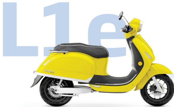
Leichtes zweirädriges Kraftfahrzeug mit bauartbedingter Höchstgeschwindigkeit von bis zu 45 km/h und bis zu 4 kW Leistung des Elektromotors
