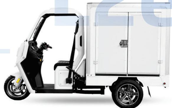
Dreirädriges Kleinkraftrad mit bauartbedingter Höchstgeschwindigkeit von bis zu 45 km/h und bis zu 4 kW Leistung des Elektromotors sowie höchstens zwei Sitzplätze
