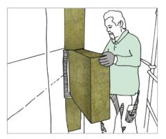
Grundsätzlich ist es möglich, jede Immobilie nachträglich mit einer Fassadendämmung aus Mineralwolle zu versehen. Dafür gibt es, je nach Gegebenheit, verschiedene Methoden: Ein **Wärmedämmverbundsystem** aus Mineralwolle hindert als Wärmebarriere die Hitze daran, in die Wand einzudringen. Auch eine **zweischalige Wand** mit einer Kern-
