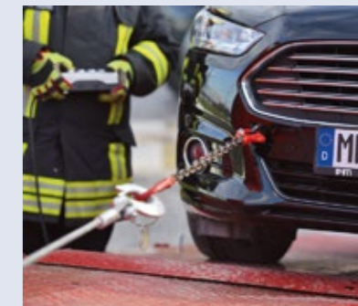
Mit der bordeigenen 80-kN-Seilwinde kön-nen E-Fahrzeuge problemlos auf den An-hänger gezogen werden. Sie wird über eine kabelgebundene Fernbedienung gesteuert.
