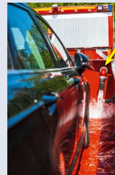
An der Stirnseite sind zwei B-Einfläufe (Pfeil) montiert, über die der Behälter bis zur Höhe der Bordwände (1,12 m) mit Was-ser geflutet werden kann. So lassen sich zum Beispiel brennende Batterien von E-Fahrzeugen kühlen.
