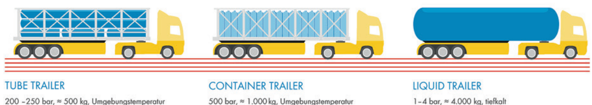
Bild 20. Straßentransport von Wasserstoff (Quelle: Shell)
