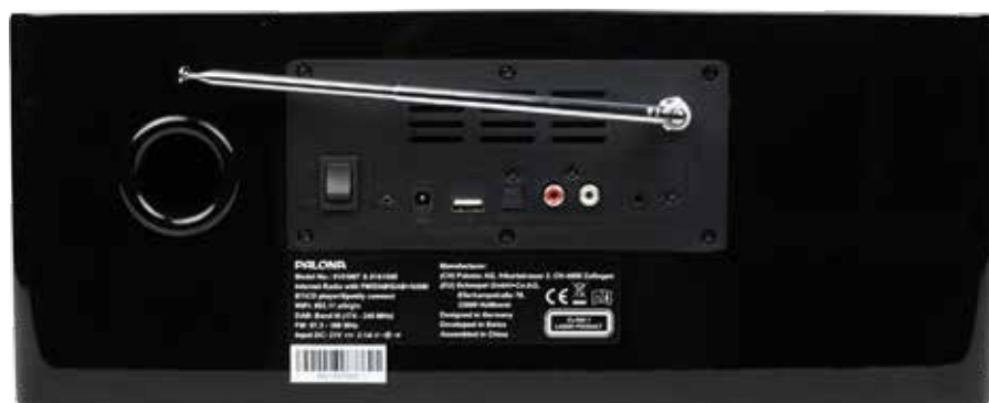
Ein Highlight ist zweifellos der optische Digitalausgang am Palona Jojo. Das Netzteil arbeitet etwas unüblich mit der krummen Spannung 21 Volt. Völlig vergessen haben die Entwickler aber offenbar den Kopfhörerausgang
