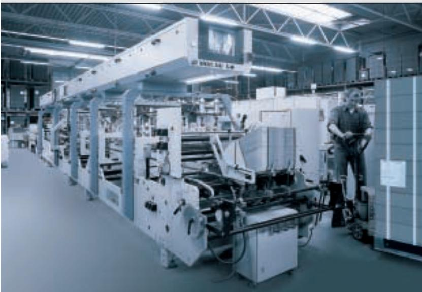
Die Speedmaster CD102 im Bild ganz links hat sieben Farbwerke und ein Lackwerk. Dass sie im Verpackungsdruck eingesetzt wird, ist daran zu erkennen: Sie steht auf einem erhöhten Fundament. So können in der Anlage und in der Auslage höhere Stapel gefahren werden – Kartonbogen sind dicker als Papierbogen –, was die Produktivität erhöht.
