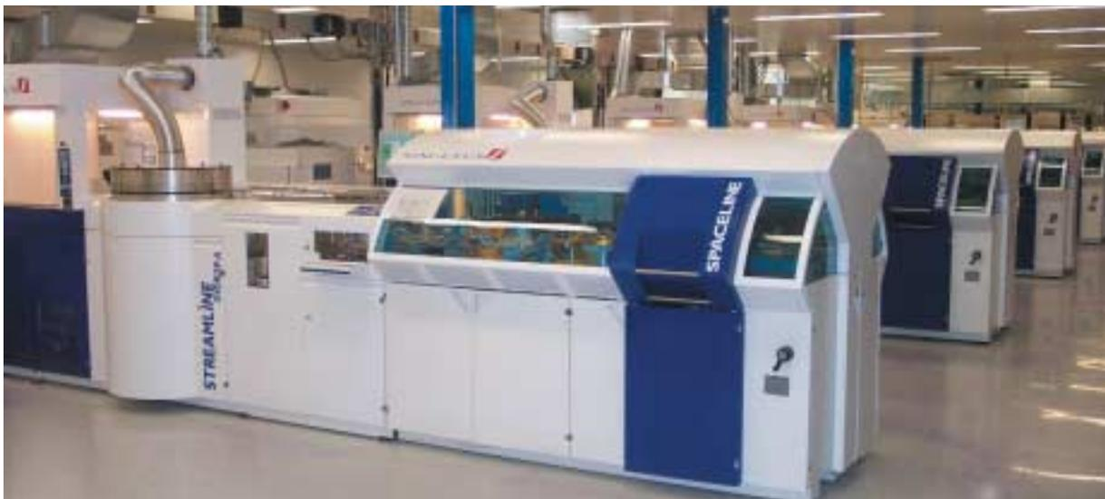
Spritzgießtechnik noch deutlich reduziert werden sollten, besitzt die STREAMLINE II ausreichende Reserven, um weiteren Prozessfortschritten noch lange folgen zu können. Die neue Anlage kann auch für CD-R Produktion eingesetzt und gleichzeitig mit 3 Spritzgießmaschinen ausgerüstet werden.
