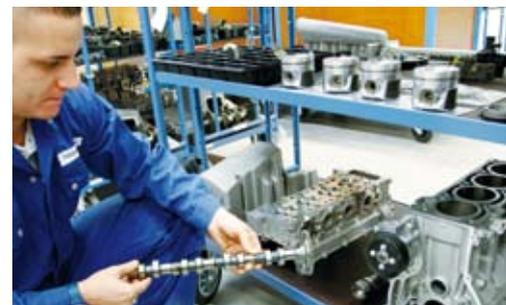
Im sächsischen Lichtenstein entstehen die CENTURION-Flugmotoren. Jeder Motor wird von einem qualifizierten Mechaniker übernommen und verantwortlich zusammengebaut: ein Mann – ein Motor.
