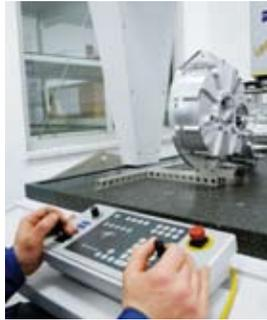
Konturen, Oberflächen, Rau- und Rundheiten sind Qualitätsmerkmale, die bei unseren Produkten genauestens geprüft werden. Alle Motoren werden vor der Auslieferung auf dem Prüfstand als Gesamtsystem auf Fehlerfreiheit und Fertigungsqualität getestet.
