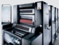
Bogenoffset-Druckmaschinen für das Format 35 x 50 cm (DIN A3)
