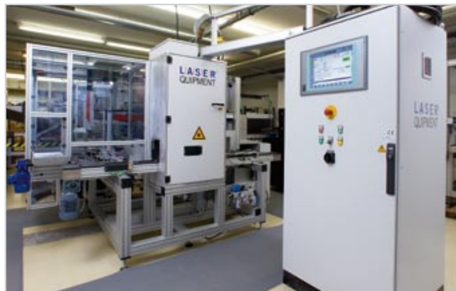
Automatische Laseranlage zum Kunststoffschweißen
