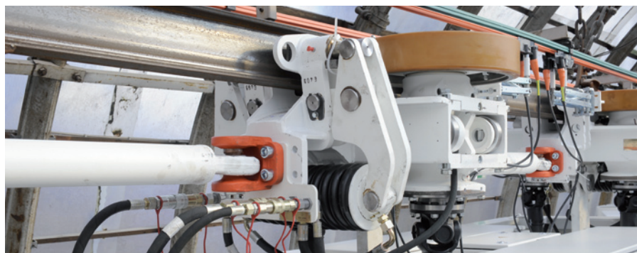
Reibräder sind das am häufigsten eingesetzte Mittel zur Kraftübertragung
