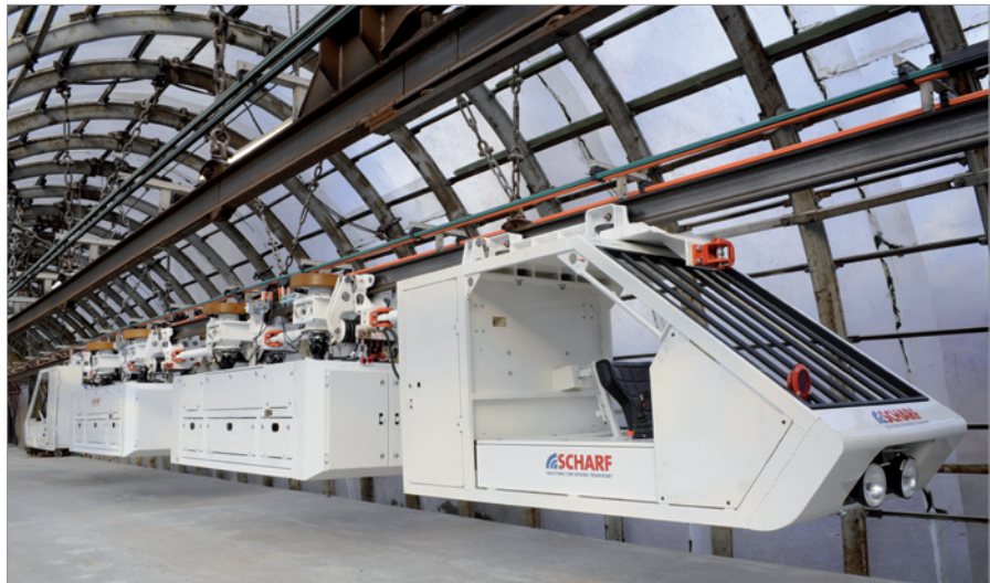
Die EMTS ist als elektrisch betriebene Einschienenhängebahn eine Alternative zum Dieselantrieb
