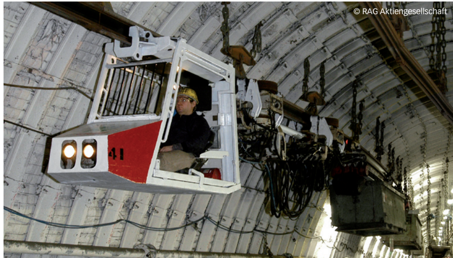
Einschienenhängebahn mit Last im Einsatz
