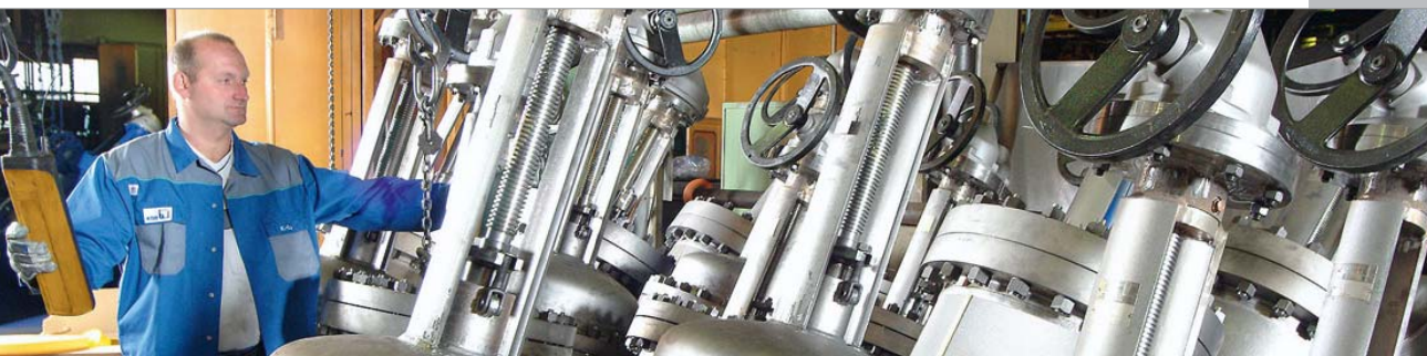
Absperrschieber zum Einsatz in einer Chemieanlage in Ungarn
