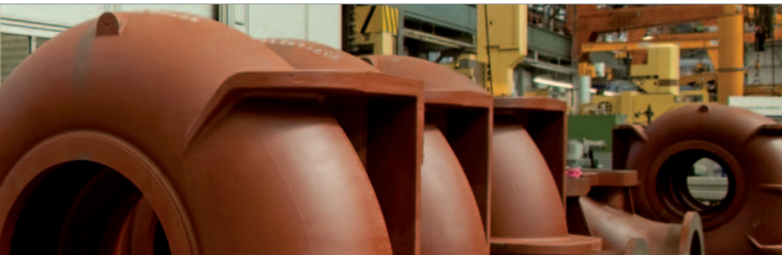
Fertigung von Tauchpumpen des Typs Amarex KRT für die Förderung von Abwasser
