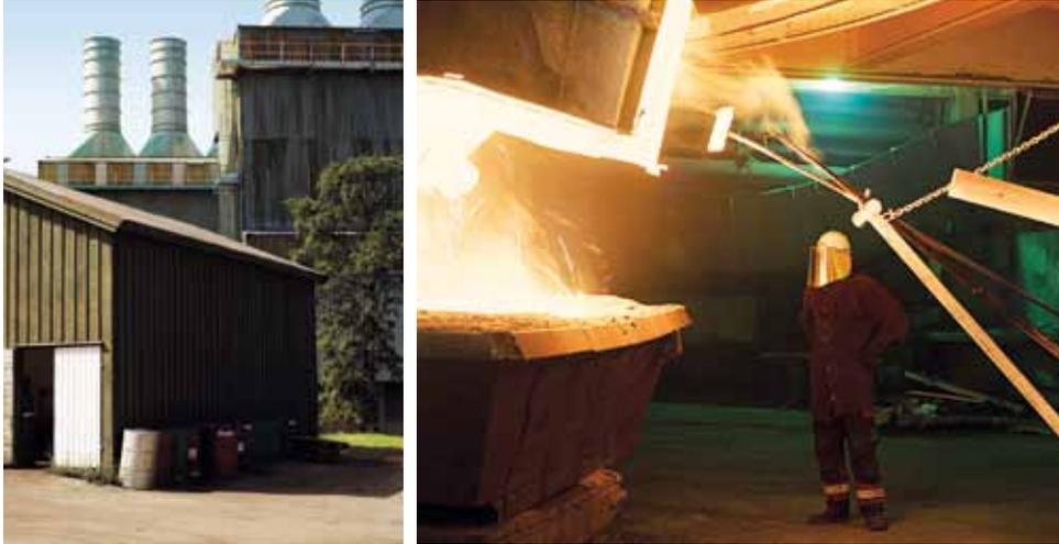
Die dunkelroten und -grünen Produktionsgebäude passen sich der Architektur der Umgebung an. In den Hallen wird es enorm heiß, wenn bei Temperaturen bis zu 2.000 Grad das Siliciummetall entsteht.
