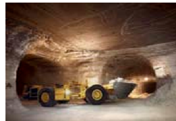
Robuste Radlader befördern in ihren mächtigen Schaufeln bis zu 20 Tonnen abgebautes Rohsalz, das sogenannte Haufwerk, zur Kippstelle im Bergwerk. Dort werden die Salzbrocken in einem Brecher zerkleinert, um dann auf langen Förderbändern zum Schacht und dann ans Tageslicht zu gelangen.
