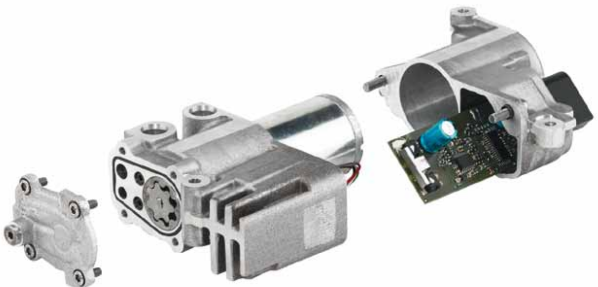
Die elektrische Zusatzölpumpe hält den Getriebeöldruck im Start-Stopp-Betrieb aufrecht.
