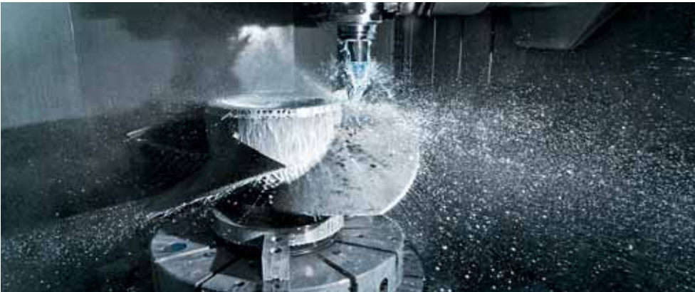
KSB-Pumpen mit Propellerlaufrädern (hier in der Bearbeitung) kommen weltweit im Hochwasserschutz und im Transport von Abwässern zum Einsatz.
