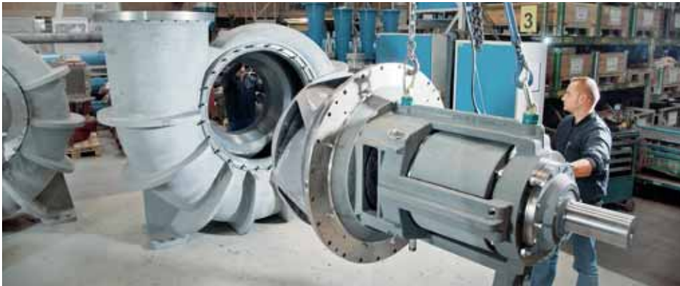
Die ersten Pumpen mit hochverschleißfesten Polymer-Laufrädern fertigen wir für eine südafrikanische Anlage zur Rauchgas-Entschwefelung.
