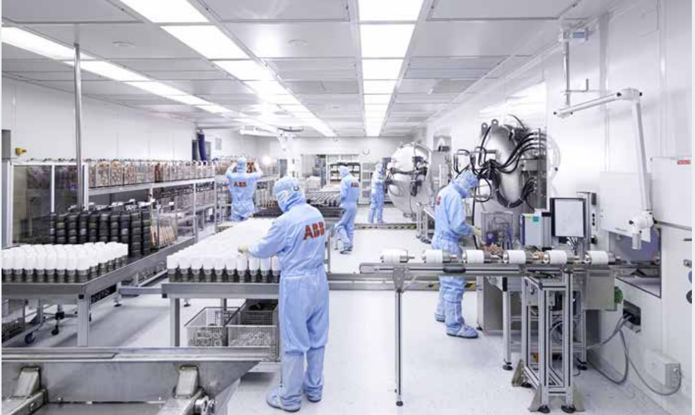
Vakuum-Schaltkammern werden im Reinraum für den Lötprozess vorbereitet
