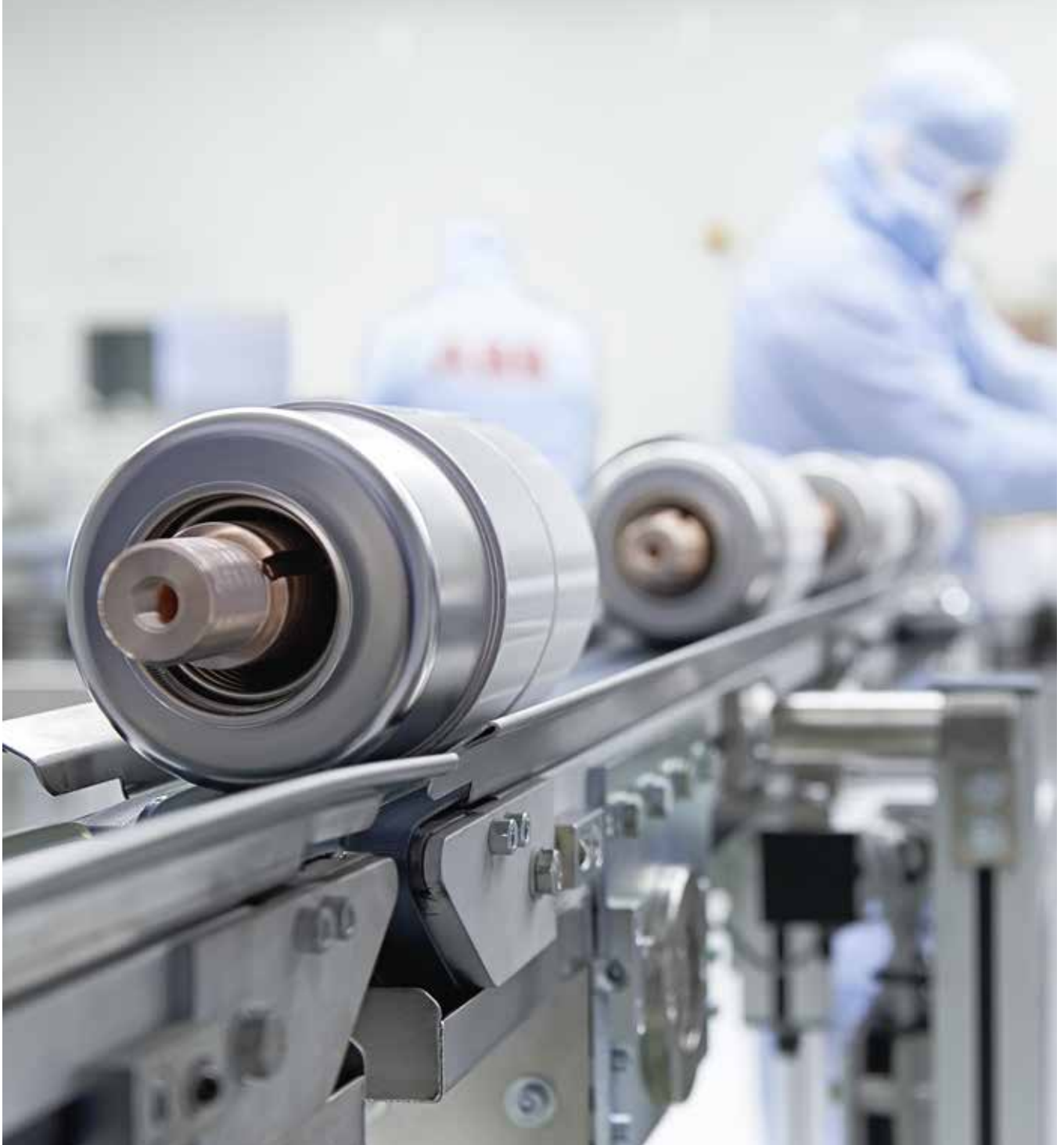
Fertig gelötete Vakuum-Schaltkammern „verlassen“ den Reinraum
