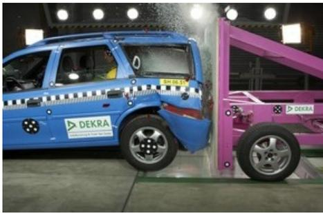
Sicherheit von Erdgasfahrzeugen: DEKRA Crashtest liefert neue Erkenntnisse. Mit 48 km/h fährt der 1814 kg schwere Stoßwagen auf der Indoor-Bahn des DEKRA Crash Test Centers Neumönster in das Heck eines stehenden Pkw-Kombi, der auf Erdgas nachgerüstet wurde. Druckbehälter und Leitungen blieben völlig dicht. Allerdings waren die beiden Dummies auf der Rücksitzbank höheren Becken- und Brustbelastungen ausgesetzt. Foto: DEKRA. Abdruck honorarfrei
