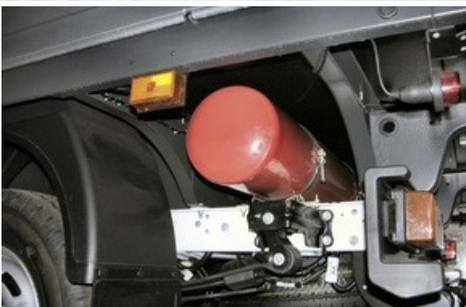
*Reichweitensteigerung fuer den Ford Transit CNG Pritschenwagen: Ab sofort betraegt das Fassungsvermoegen der Erdgastanks - im Bild einer der Tanks ohne Abdeckung - 168 Liter (=30 kg) Erdgas. Hinzu kommt der serienmaessige 80-Liter-Benzintank. Die Verwendung dieses Bildes ist fuer redaktionelle Zwecke honorarfrei. Abdruck bitte unter Quellenangabe: "obs/Ford Werke GmbH"*
